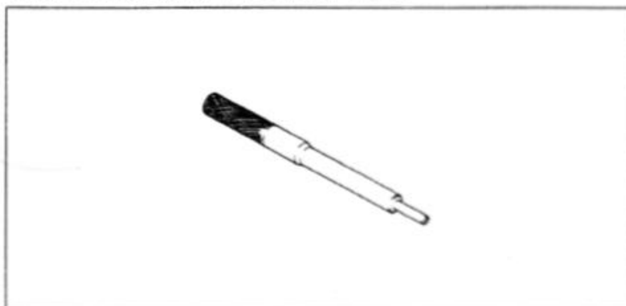
Valve Guide Reamer, \Phi 4 : 57001-1274
