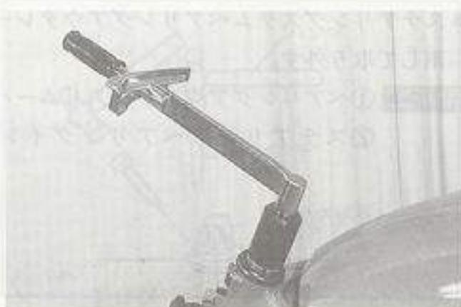
**△注意** ステアリングステムナットの最終的な調整はホイール、ハンドル等が組み立てられている状態でスムーズに回転するように調整すること。
